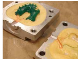
モデルを埋没し、ワックスを溶かします。型を開きレジンを取り出す
